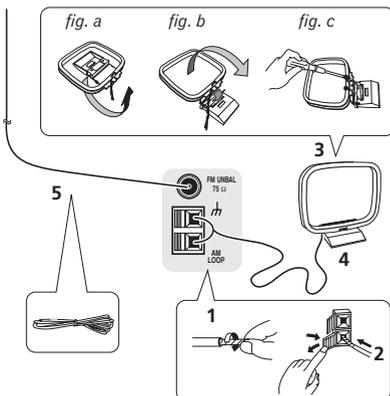
**1** Retirez les écrans protecteurs des deux fils de l'antenne AM.
