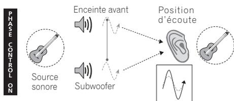
La technologie Phase Control garantit une reproduction cohérente du son, grâce à l'utilisation de la correspondance de phase<sup>1</sup> qui permet d'obtenir une image sonore optimale à la position d'écoute. La fonction Phase Control est activée par défaut et nous vous recommandons de la laisser activée pour tous les types de source sonore.
