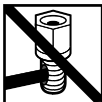
Do not insert insulated section of speaker wire No inserte alambre con material aislante Ne pas insérer la partie isolée du fil du haut-parleur Isolation des Lautsprecher-Drahtes nicht in das Loch schieben
