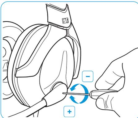
La sensibilité du microphone est pré-réglée d'usine sur 35 mV/Pa.
