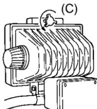
**Paso 2:** Alinear los orificios roscados para tornillos en el asa con los dos orificios en el tubo y fijarla con los dos tornillos suministrados.
