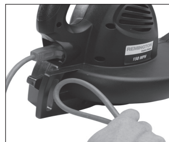
Figura 4 - Inserción del lazo del cordón de extensión en la ranura para el cordón
