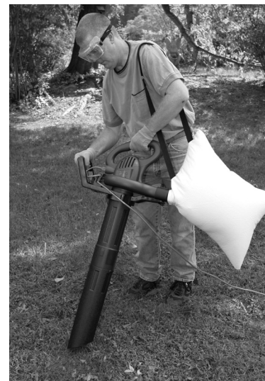
Figure 4-8 : Ramassage des débris au moyen de l'aspirateur
