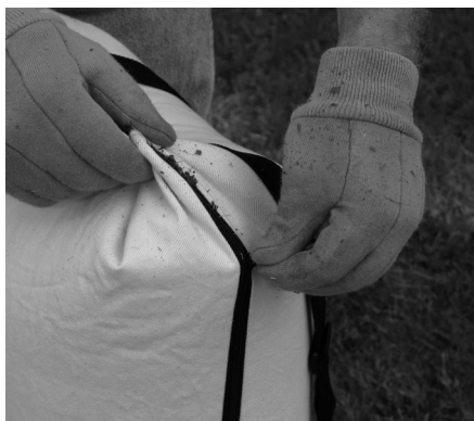
Figura 4-10. Abertura de la cremallera y vaciado de la bolsa
