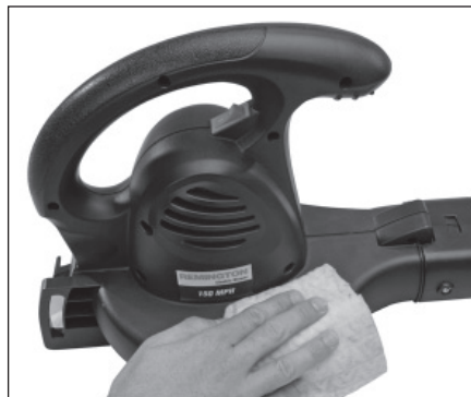
Figura 9 - Limpieza de la carcasa de la sopladora
