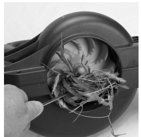
Figura 4-14. Retiro desechos de los impulsores
