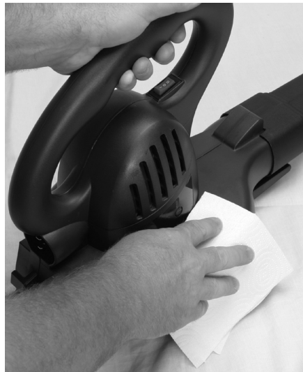
Figura 5-1: Limpieza de la carcasa de la sopladora/aspiradora
