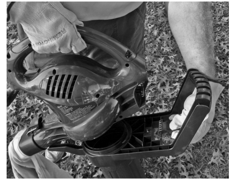
Figure 4-13 : Retrait de l'adaptateur du tube d'aspirateur
