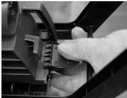
Figure 4-12 : Appuyez sur le levier de verrouillage
