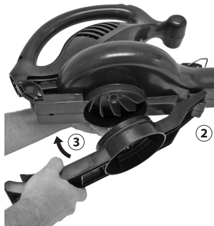
Figura 3-3: Sujeción de la tapa de la entrada inferior al enganche de la caja del motor
