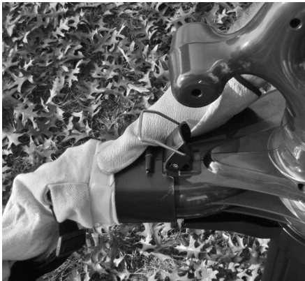
Figura 4-10. Retiro del conjunto bolsa/adaptador
