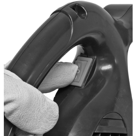
Figure 4-6 : Commutateur de l'interrupteur en position inférieure
