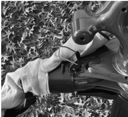
Figure 4-10 : Retrait de l'ensemble adaptateur/sac
