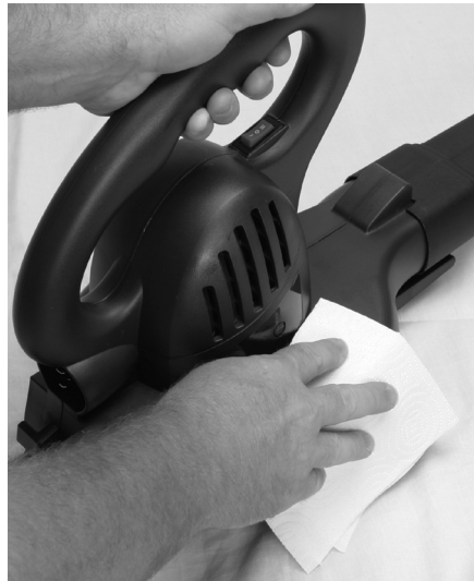
Figure 5-1 : Nettoyage du boîtier du souffleur / aspirateur
