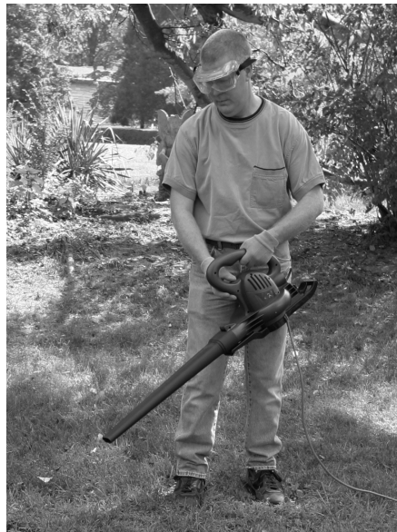
Figura 4-5: Sosteniendo la sopladora/aspiradora para que opere como sopladora
