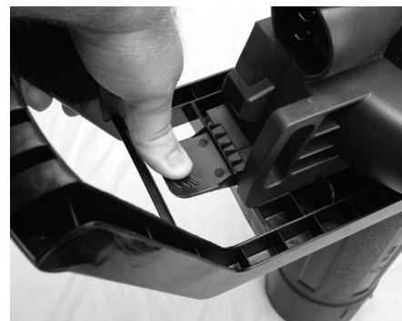
Figure 3-12 : Appuyez sur le levier de verrouillage
