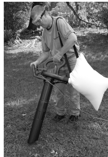
Figure 4-9 : Ramassage des débris au moyen de l'aspirateur
