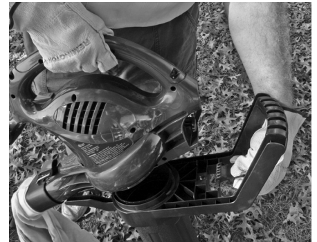
Figura 4-13. Retiro del adaptador del tubo de aspiración
