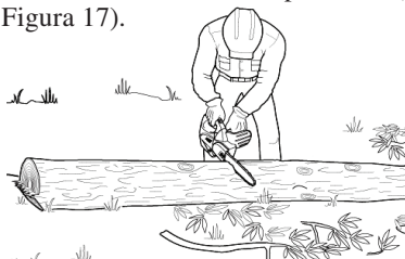
Figura 17 - Trozado del tronco completamente apoyado en el suelo
