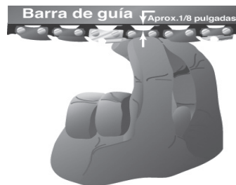
Figura 8 - Compruebe la tensión de la cadena
