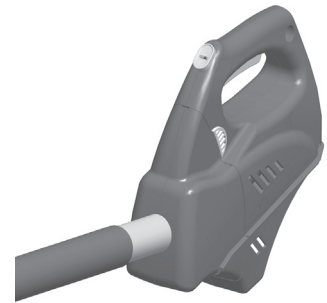
Figura 25- Mango principal y adaptador del mango ensamblados
