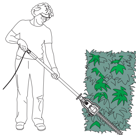
Figure 14 – Taille de la partie inférieure et des côtés des haies et des buissons
