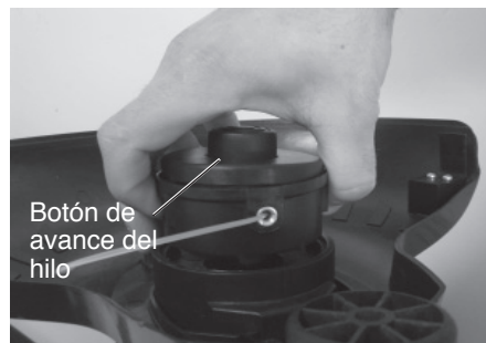
Figura 21 - Avance de la cuerda de la podadora/recortabordes
