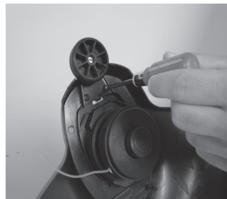
Figura 9 - Sujeción de la rueda de la recortabordes
