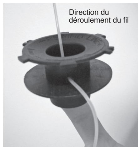
Figure 24 - Insertion du fil dans l'orifice de droite
