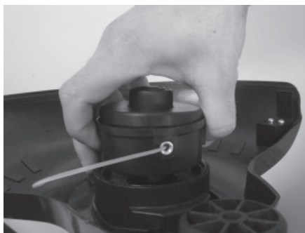
Figure 21 - Déverrouillage du couvercle de la bobine
