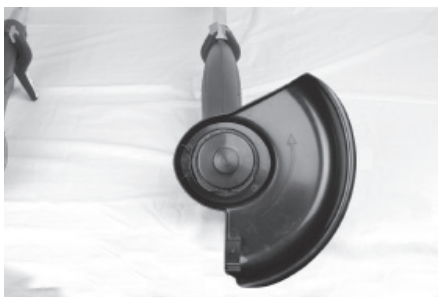
Figure 4 - Installation du protecteur de coupe sur la tête de l'outil
