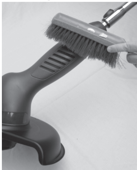
Figure 30 - Nettoyage du boîtier du taille-bordures / coupe-bordures
