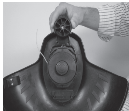
Figure 8 - Mise en place du disque de coupe sur les orifices des vis
