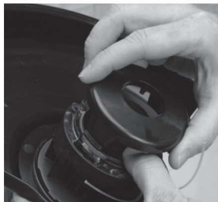
Figure 28 - Mise en place du couvercle de la bobine sur le boîtier
