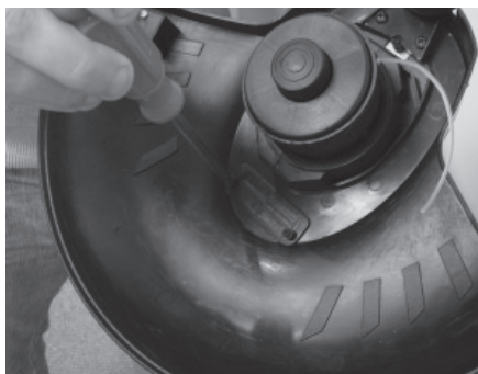
Figure 7 - Insérez les deux vis de montage
