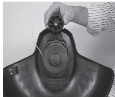
Figura 8 - Colocación de la rueda de la recortabordes sobre los orificios de los tornillos
