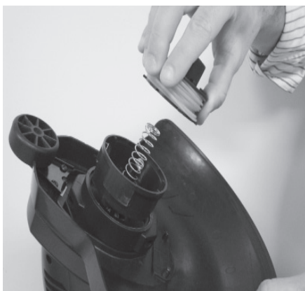
Figure 22 - Retrait du couvercle de la bobine et de la bobine
