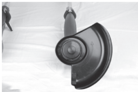
Figura 4 - Colocación del protector de corte sobre la cabeza de corte
