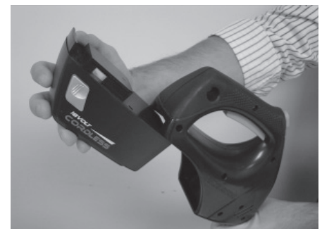
Figura 16 - Colocación de la batería en la podadora
