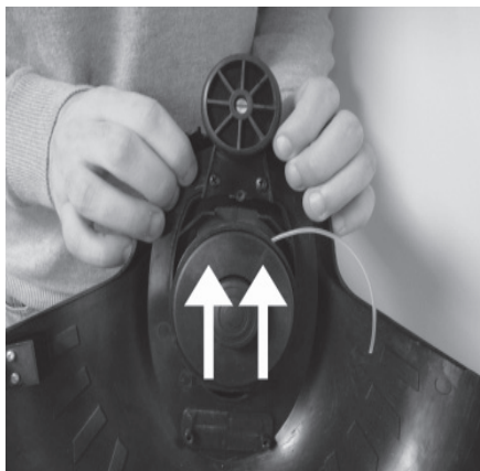
Figura 5 - Deslice hacia delante el protector de corte
