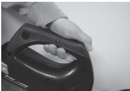
Figura 18 - Presione el botón de bloqueo y apriete el gatillo
