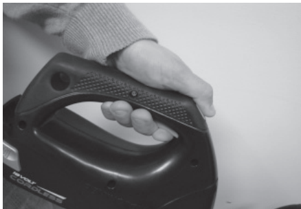
Figure 18 - Enfoncez le bouton de verrouillage, puis appuyez sur la gâchette.
