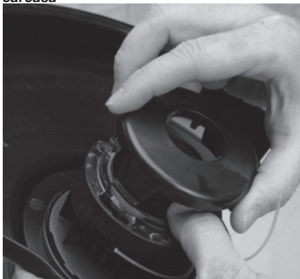
Figura 28 - Reposición de la tapa del carrete en la carcasa
