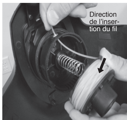
Figure 26 - Insertion de la cordelette dans le boîtier.
