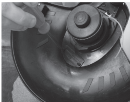
Figura 7 - Inserte dos tornillos de montaje
