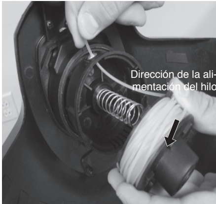
Figura 26 - Inserción del hilo de corte por la caja
