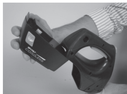
Figure 16 - Placez la pile, complètement chargée, dans le taille-haie.
