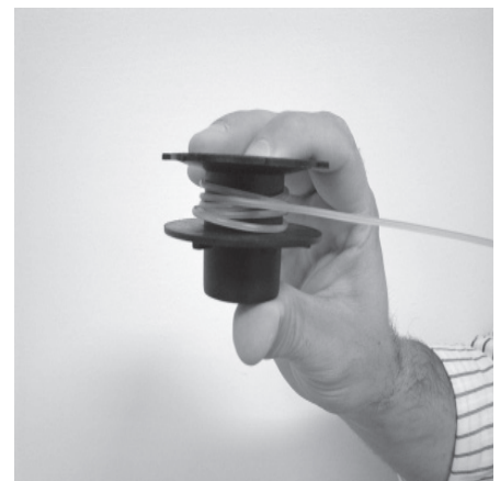
Figura 25 - Línea de viento alrededor de carrete
