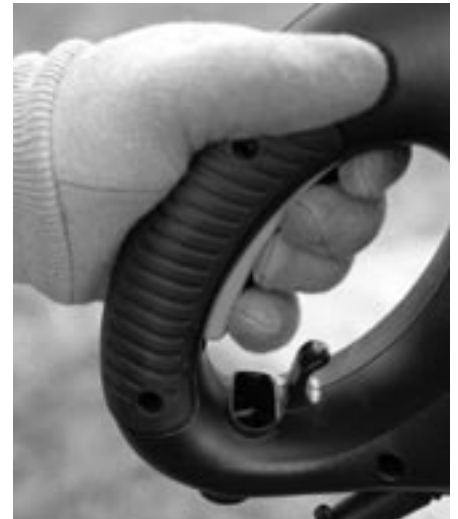
Figura 3-7: Apriete el interruptor trasero del gatillo para arrancar la podadora
