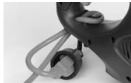
Figure 3-3 : Tirez sur la poignée pour l'insérer solidement dans le dispositif de retenue
