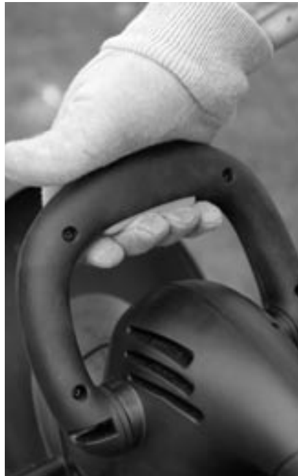
Figure 3-6 : Position de la main sur la poignée avant
