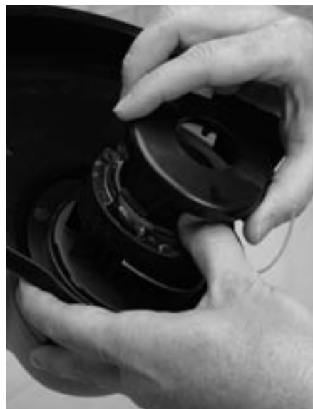
Figura 4-26: Reposición de la tapa del carrete en la carcasa
