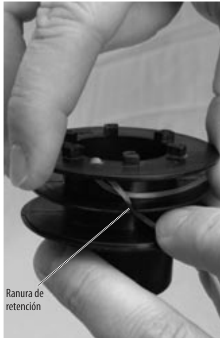
Figura 4-20: Colocación de la cuerda en el carrete
