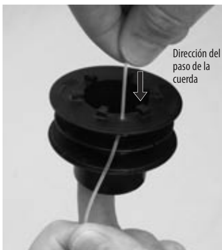
Figura 4-17: Insertando la cuerda en el orificio izquierdo
