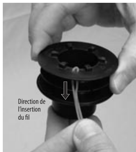
Figure 4-19 : Tirez fermement sur le fil
