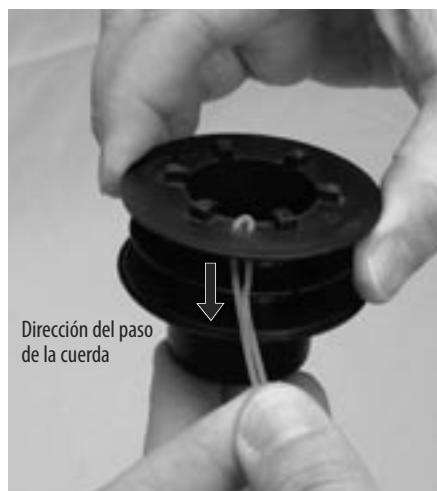
Figura 4-19: Halado y apretado de la cuerda
