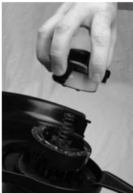
Figura 4-14: Retiro de la tapa y del carrete
