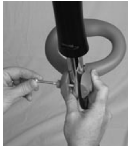
Figura 3-8: Inserción del perno en el asa
