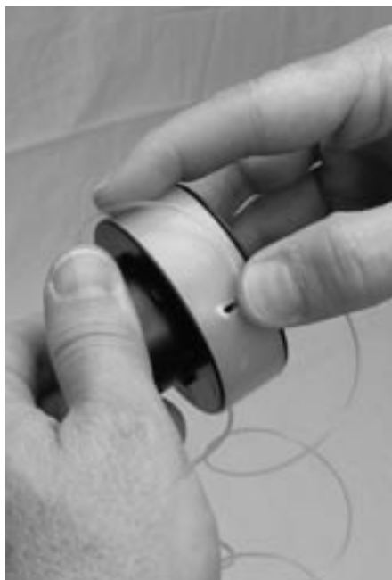
Figura 4-24: Envolviendo la cuerda en el carrete
