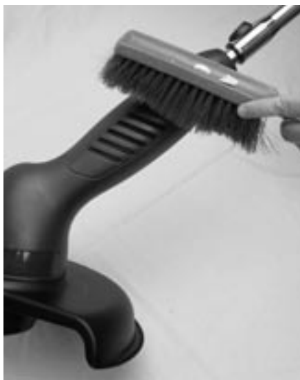
Figure 5-1 : Nettoyage du boîtier du taille-bordures / coupe-bordures
