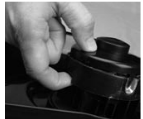
Figure 4-13 : Déverrouillage du couvercle de la bobine
