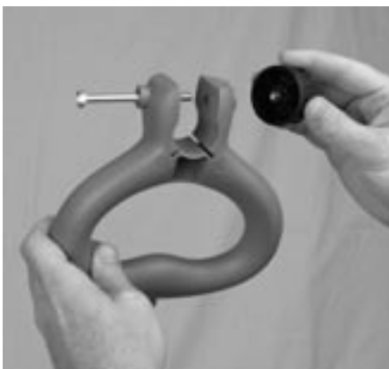
Figure 3-6 : Retrait du bouton et de l'écrou de la poignée
