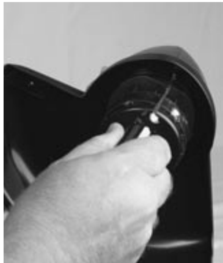
Figura 3-3: Sujeción del tornillo de montaje
