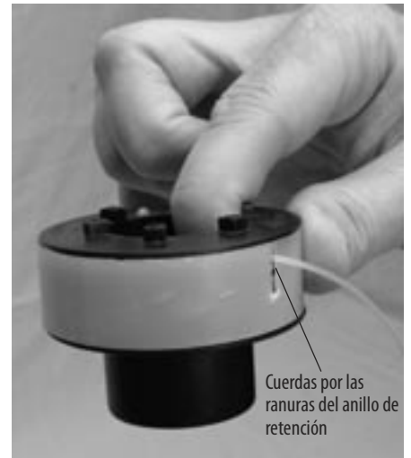
Figura 4-23: Ubicación de la cuerda en las ranuras del anillo de retención
