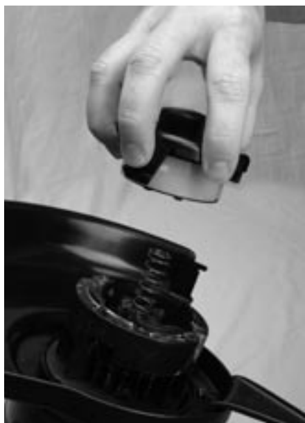
Figure 4-14 : Retrait du couvercle de la bobine et de la bobine
