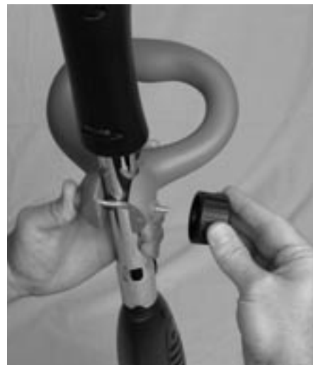
Figura 3-9: Atornillado de la perilla en el perno
