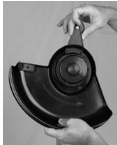
Figura 3-4: Colocación de la rueda de la recortabordes sobre los orificios de los tornillos
