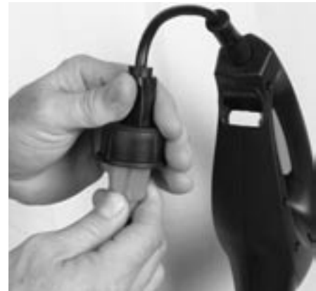
Figura 4-1: Enchufando el cordón de extensión en el cordón de alimentación. Modelo ST4514B
