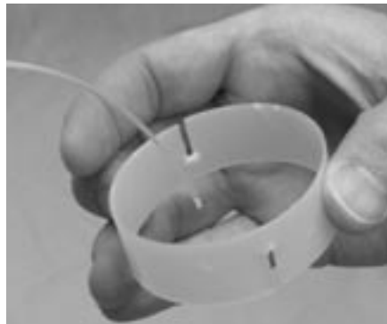
Figura 4-21: Colocación de la cuerda del carrete superior en el anillo de retención
