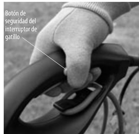
Figura 4-10: Apriete del interruptor de gatillo
