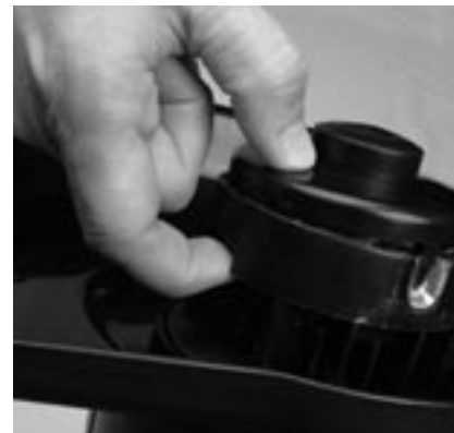
Figura 4-13: Desbloqueando la tapa del carrete
