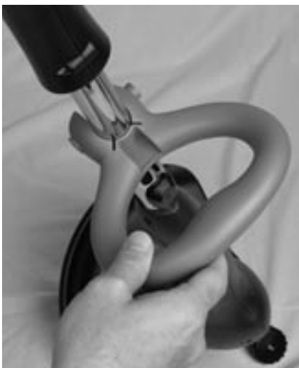
Figura 3-7: Colocación del asa en el eje
