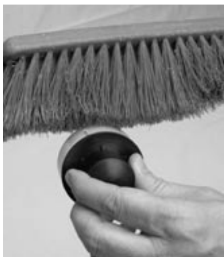
Figura 4-15: Limpieza del carrete
