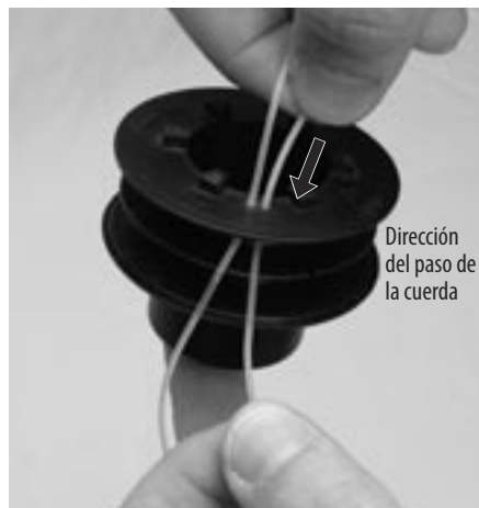
Figura 4-18: Inserción la cuerda en el orificio derecho
