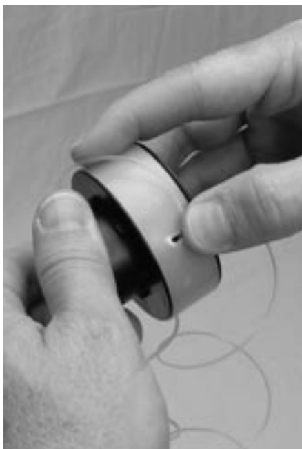
Figure 4-24 : Enroulement du fil sur la bobine
