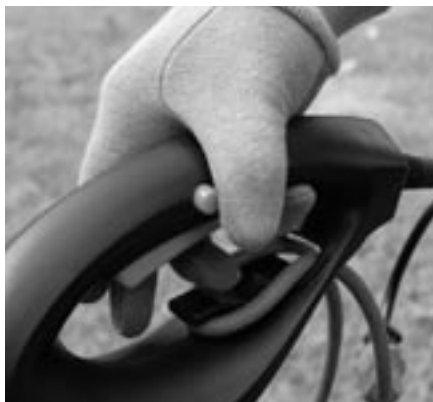
Figura 4-8: Sosteniendo el asa posterior de la podadora/recortabordes
