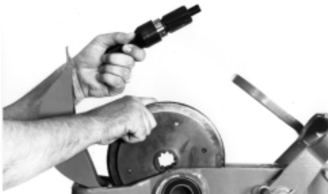
Figure 12 – Retrait du disque de tronçonneuse
