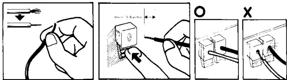
必ずスピーカー端子を正しく接続してください。逆方向で接続すると故障の原因となります。
