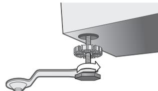
7. Mettez votre laveuse à niveau en tournant les pieds vers la gauche ou la droite manuellement ou à l'aide de la clé anglaise fournie avec votre laveuse. Lorsque la laveuse est de niveau, serrez les écrous à l'aide de la clé anglaise ou d'un tournevis.
