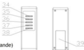
Insérez deux piles AAA 1.5 v (non fournies) en respectant la polarité indiquée dans la partie droite du compartiment. Les piles alcalines sont recommandées, car celles-ci offrent une longue autonomie.
