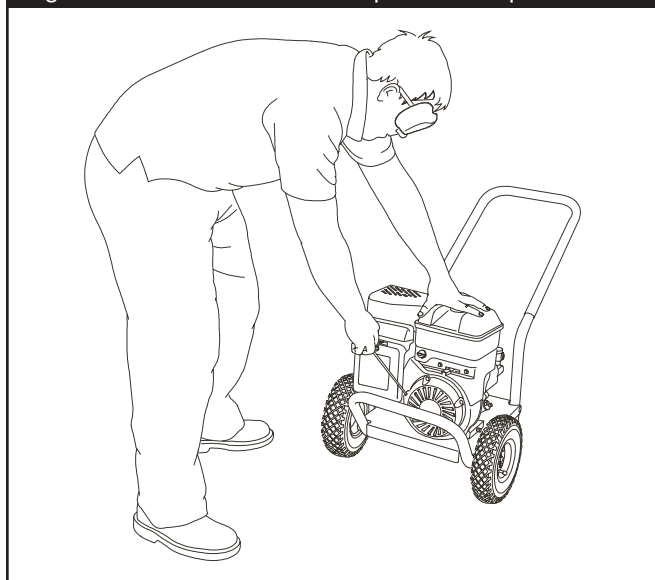
Figura 30 - Posición Recomendada para el Arranque
