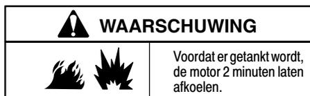
Reinigen rond de brandstof vulopening voordat de tankdop verwijderd wordt. Vul de tank tot ongeveer 4 cm onder de bovenkant van de vulopening om de brandstof te kunnen laten uitzetten. Wees voorzichtig niet te overvullen.
