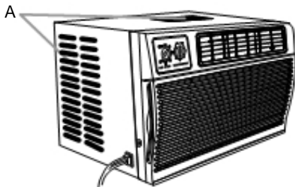
A. Cabinet louvers
