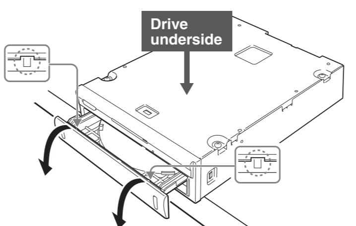
**CT** 輕輕拉出碟片托盤，並取下裝飾板。
