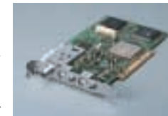
TVチューナー内蔵MPEG2リアルタイムエンコーダーボード
