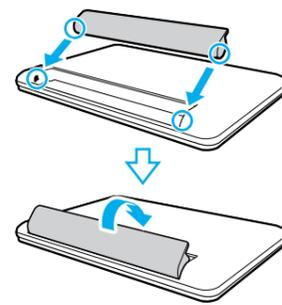
Déverrouillez le verrou **LOCK** de la batterie avant d'installer la batterie, puis verrouillez-le après l'installation.
