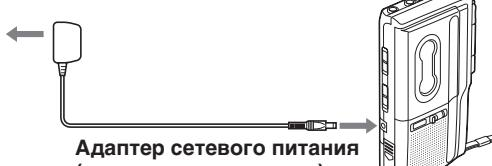
Подключите адаптер сетевого питания к гнезду DC IN 3V и к сетевой розетке. Пользуйтесь прилагаемым адаптером AC-E30HG (в комплект не входит).
