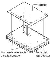
Deslice la batería en la dirección que indica la flecha hasta que se ajuste con un clic.
