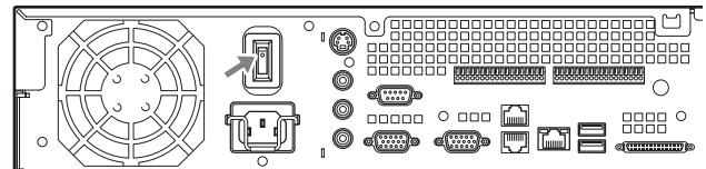
Lorsque le démarrage est terminé, la diode Power s'allume en vert.
