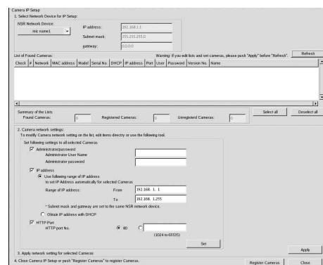
Nella finestra Impostazione IP telecamera è possibile cercare telecamere che si trovano sulla stessa rete mediante l'indirizzo MAC e configurarne gli indirizzi IP nella stessa operazione.
