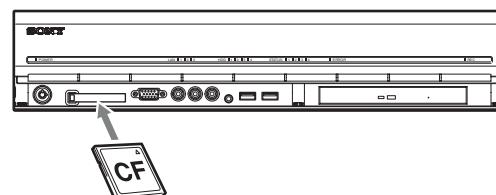
Al expulsar una tarjeta CompactFlash, pulse el botón de expulsión situado a la izquierda de la ranura de la tarjeta.
