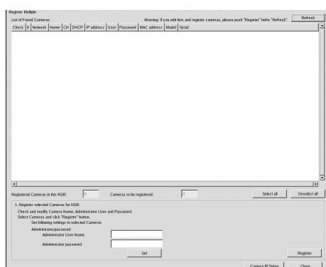
Nel riquadro Registrazione simultanea, viene visualizzato un elenco delle telecamere che non sono state registrate sull’unità NSR con le relative caselle di controllo selezionate.
