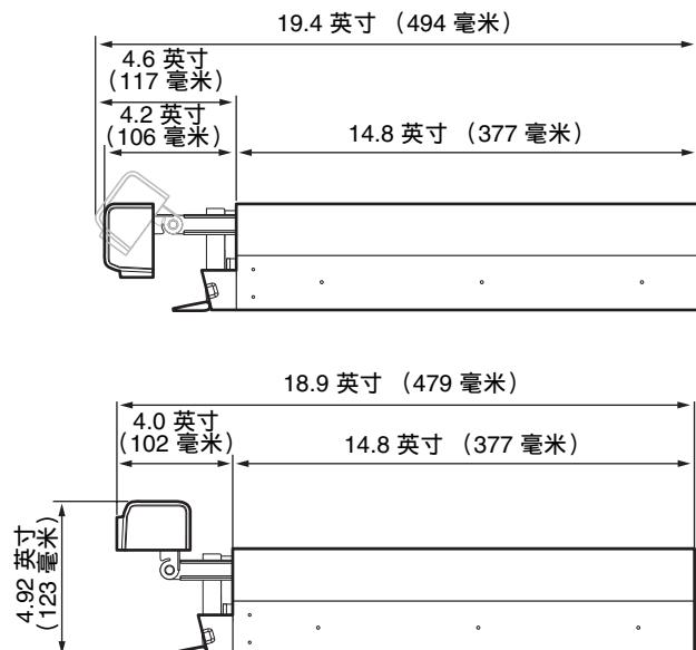
您可以将 NSR 安装在机架或平面上。如果您计划将其安装在平面上，则必须在机盘底部垫上附送的橡胶脚垫。
