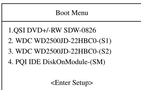
3 使用键盘上的箭头键选择 [IDE DiskOnModule]，然后按 Enter。开始从 DiskOnModule (DOM) 启动。
