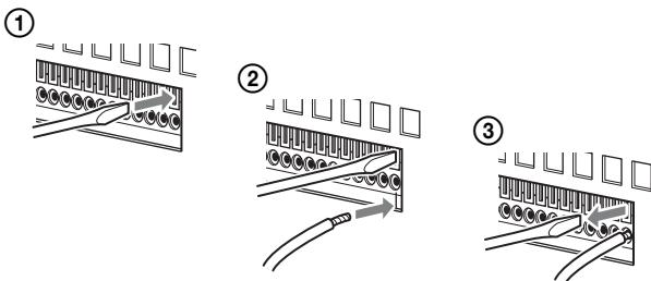
重复此步骤连接所有需要的电线。
