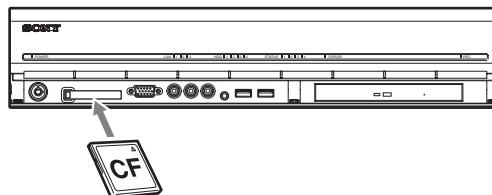
Per espellere una scheda CompactFlash, premere il pulsante di espulsione situato a sinistra dello slot della scheda.
