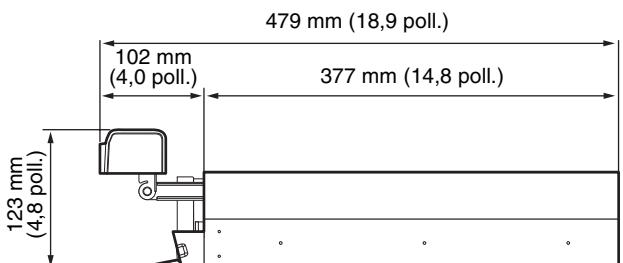
È possibile installare NSR su rack o su una superficie piana. Per installarlo su una superficie piana, è necessario applicare i piedini in gomma in dotazione alla parte inferiore dello chassis.
