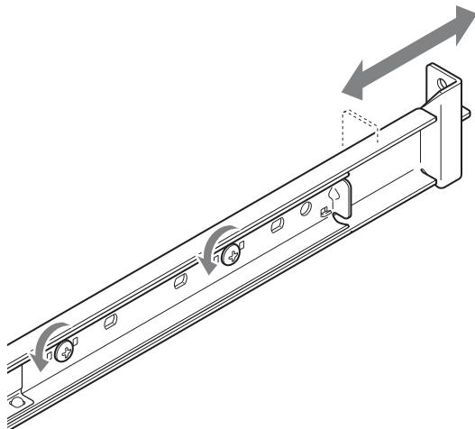
(2) 使用随附的铆钉和垫圈将导轨的两端固定在机架上。
