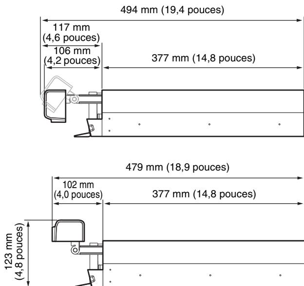
Vous pouvez installer le NSR dans un montage en châssis ou sur une surface plane. Si vous prévoyez de l'installer sur une surface plane, vous devez fixer les pieds en caoutchouc fournis au fond du châssis.
