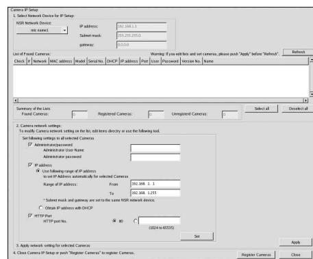
En la ventana de configuración de la IP de la cámara, es posible buscar las direcciones MAC de las cámaras de la misma red y configurar sus direcciones IP a la vez.
