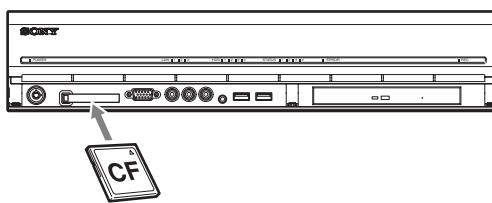
Drücken Sie zum Auswerfen einer CompactFlash-Karte die Taste links neben dem Kartenschacht.
