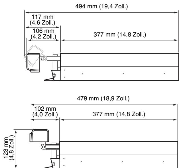
Sie können den NSR in einem Rack montieren oder auf einer ebenen Oberfläche aufstellen. Wenn Sie das Gerät auf einer ebenen Oberfläche aufstellen, müssen Sie die mitgelieferten Gummifüße an der Unterseite des Gehäuses anbringen.
