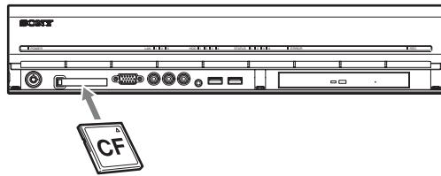
弹出 CompactFlash 卡时, 请按卡插槽左侧的弹出按钮。
