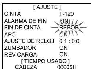
**REBOB:** cuando la cinta llega al final, la videograbadora la rebobina automáticamente y entra en el modo de parada al principio de dicha cinta.
