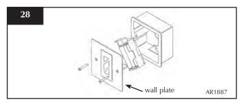
PLEASE ENSURE NO WIRES ARE TRAPPED BEFORE REPLACING THE WALL PLATE. THE TOUCH PAD LEAD IS EASILY DAMAGED.
