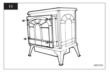
NEVER OPERATE THE STOVE WHEN THE DOOR IS REMOVED.
