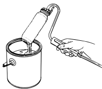
1. Nettoyage du revêtement du rouleau.
