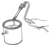
2. Élimination de la peinture se trouvant dans le tuyau flexible.
