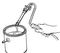
2. Elimine la pintura de la manguera.
