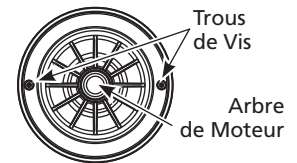
Figure 15 - Remplacement de Plaque d'Étanchéité
