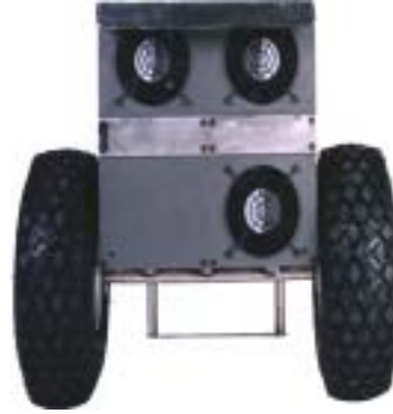
Back Vent/Cooling Fan
