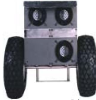
Back Vent/Cooling Fan
