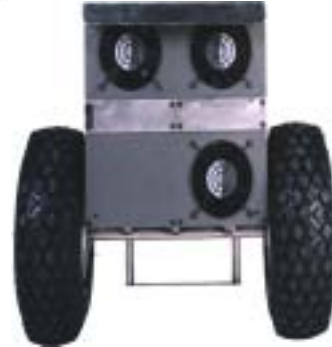
Back Vent/Cooling Fan
