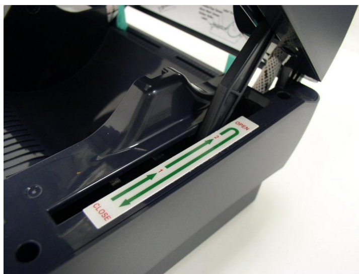
Fig. 1 El soporte de la tapa superior está fijado en la posición 2
