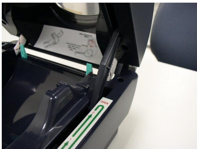
Fig. 2 La tapa superior está completamente abierta y lista para ser cerrada
