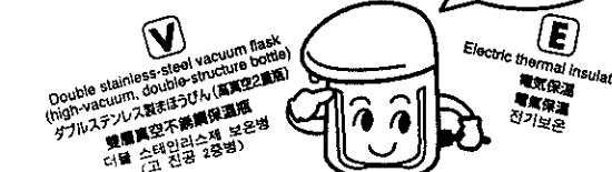
ダブルステンレス製まほうびんの高真空2重瓶と電気保温を併用した経済的な保温方式。194F保温との組合せで、さらに保温時の電気代が節約できます。
