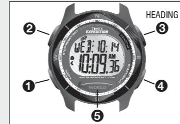
Appuyer sur **1** pour alterner entre : l'heure et la date, le chronographe, le compte à rebours et l'alarme. La boussole est accessible dans tous les modes sauf l'alarme. Appuyer sur **3** (HEADING) pour afficher la boussole.
