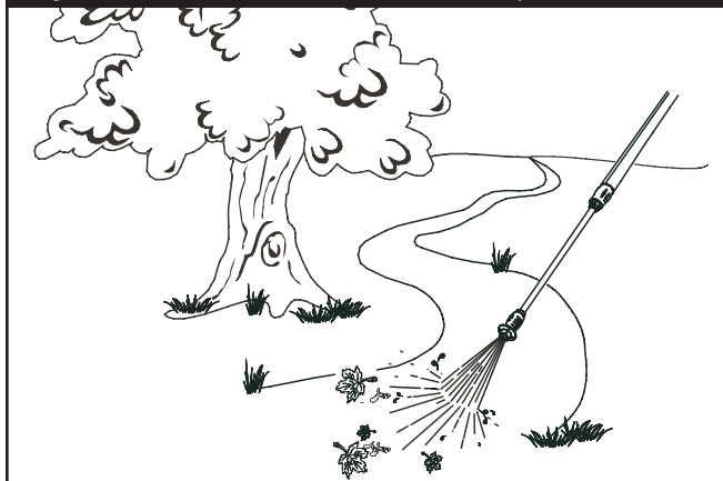
Figura 26 — Poner a Prueba el Patrón de Aspersión
