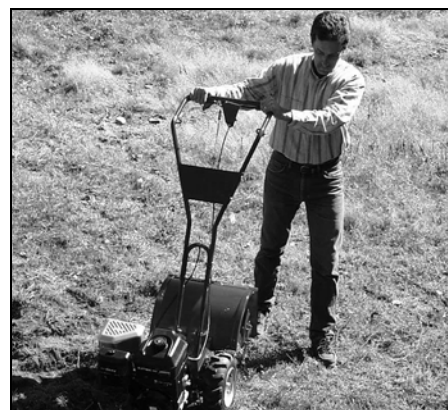
Fig. 4-5: Con los dientes separados del suelo, empuje las barras de control hacia el costado
