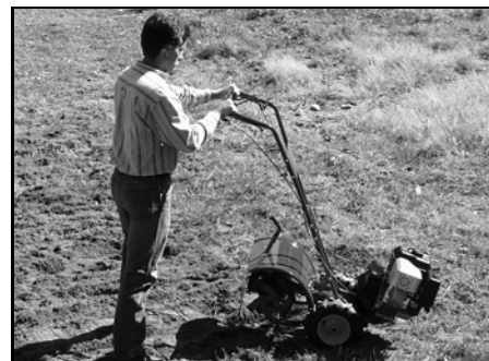
Fig. 4-4: Para comenzar a dar la vuelta, levante las barras de control hasta que los
