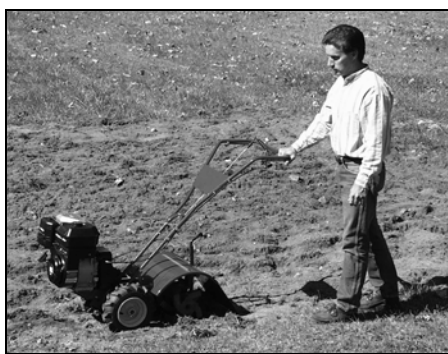
Fig. 4-2: Use una mano para guiar la cultivadora al moverse hacia adelante.
