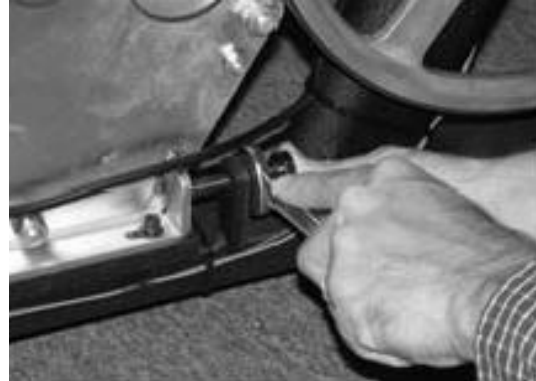
Step 3. Loosen Nut
