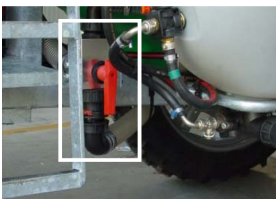
Deviatore di aspirazione
