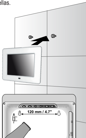
Instalación en la pared
