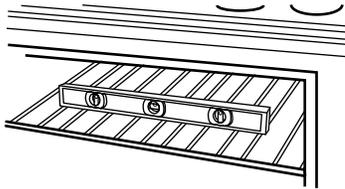
3. Si la cuisinière n'est pas d'aplomb, la tirer de nouveau de façon à ce que le pied de nivellement arrière se dégage de la bride antibasculement. Utiliser une clé à cliquet de  $\frac{3}{8}$ " et une pince multiprise pour régler les pieds de nivellement vers le haut ou vers le bas jusqu'à ce que la cuisinière soit d'aplomb.
