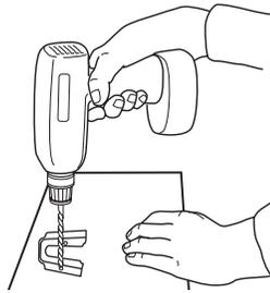
Pour monter la bride antibasculement sur un plancher en béton ou en céramique, utiliser un foret à maçonnerie de  $\frac{3}{16}$ " (0,48 cm) pour percer 2 trous aux emplacements indiqués sur le gabarit de la bride. Enlever le gabarit du sol.
