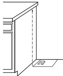
Si l'ouverture du placard est plus large que ce qui est spécifié dans la section "Exigences d'emplacement", ajuster le gabarit de sorte que la cuisinière soit au centre de l'ouverture du placard.
