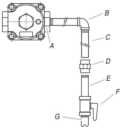
A. Raccord à compression du détendeur
