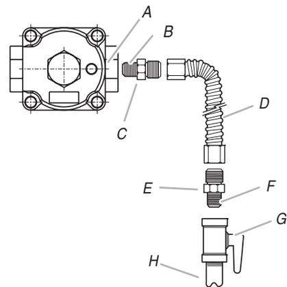
A. Raccord à compression du détendeur
