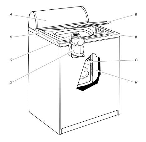
A. 控制面板 B. 型号和系列码标签 C. 液体柔顺剂分配器 D. 搅拌机 E. 盖子 F. 液体氯漂白剂分配器 G. 洗衣篮 H. 洗衣缸
