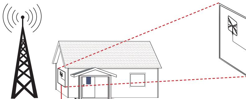
■ Si la antena es montada de manera que cuelgue verticalmente, Monte la antena de manera que el cable coaxial corra de la parte superior o inferior de la antena. Si la antena es montada de manera que quede plana (por ej., sobre una mesa), el cable coaxial deberá apuntar hacia la torre de la señal.
