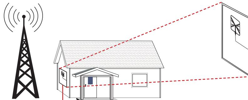
■ Montar la antena en una ventana en dirección a la torre de transmisión de las estaciones que desea recibir. Los lados de la antena tienen puntos ciegos, de manera que la antena no "verá" la señal de la torre de transmisión si los lados de la antena apuntan hacia la torre.
