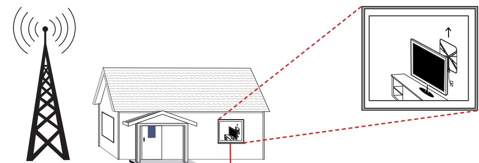
■ El cable coaxial corre desde un lado de la antena en lugar de la parte superior o inferior de la antena. Intente re orientar la antena para que el cable coaxial se extienda desde la parte superior o inferior de la antena, y realice de nuevo un escaneo de canales.
