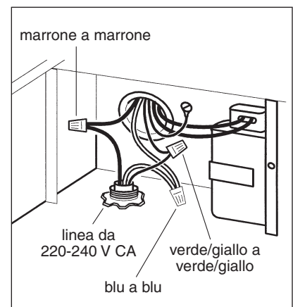
Connessioni di cablaggio
