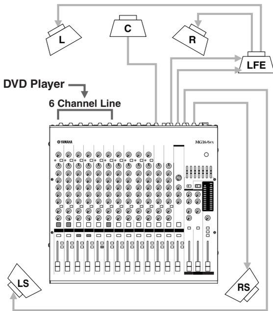
Wenn Sie ein gewöhnliches Mischpult verwenden, das nicht speziell auf die Surround-Produktion ausgerichtet ist, können Sie Ihre Hauptlautsprecher L und R über den Subwoofer HS10W an ein beliebiges Stereo-Ausgangspaar anschließen, während der Center- und die hinteren Lautsprecher an einzelne Ausgangskanäle angeschlossen werden.
