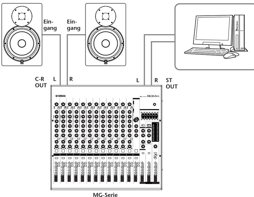
Wenn Sie Ihre HS-Lautsprecher direkt mit einem Mischpult verbinden, z. B. einem der Mischpulte der MG-Serie von Yamaha, sollten diese normalerweise an den Ausgängen „C-R“ (Control Room) angeschlossen werden, so dass Sie die Abhörlautstärke unabhängig von dem Signal regeln können, das an den Hauptausgängen des Mischpults anliegt, und welches Sie in einer Produktionsumgebung zur Aufnahme an Ihren Rekorder oder Ihre DAW (Digital Audio Workstation) senden.
