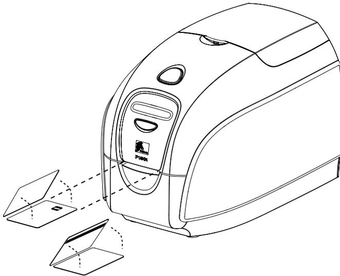
对于磁条卡，如果要在带有磁条的一侧打印，应将磁条面朝上插入，从前端查看时，磁条应朝向打印机的右侧。
