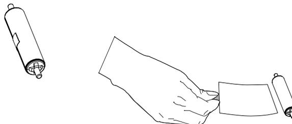
7. 将清洁滚轮放置在清洁带中，关闭盖子，并将其插入到位，以让锁扣接合。
