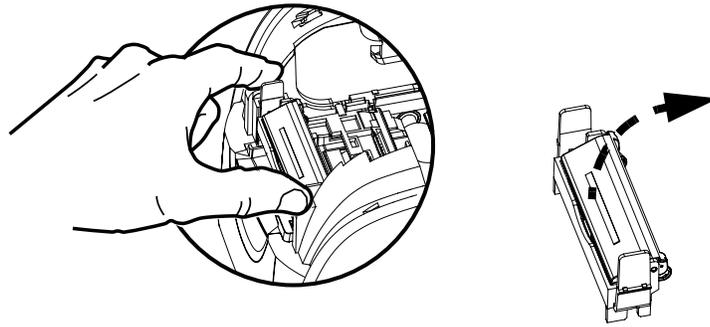
4. 提起清洁带的盖子。新打印机配备了带有保护包装的清洁滚轮。当清洁滚轮已脏时，应更换。
