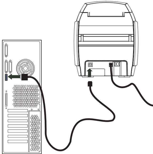
6. 如果您的打印机除 USB 接口外，还具有选配的以太网接口，既可以使用 USB 缆线连接打印机和计算机，也可以使用以太网线连接打印机和以太网网络。
