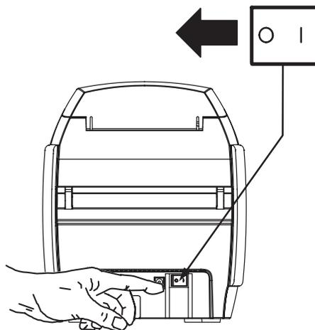
4. 将电源插头插入电源插座，将电源线（120 伏交流或 230 伏交流）连接到电源，然后将电源线插入具有正确电压和类型的接地电源插座。
