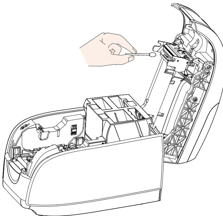
4. 应先让打印头干燥两到三分钟，然后再将打印机电源开关置于“打开”(I)位置。
