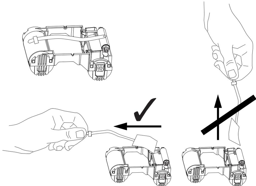
3. 将色带夹插入，让清洁滚轮面朝下，以使滚轮末端的齿轮嵌入对应的槽中。
