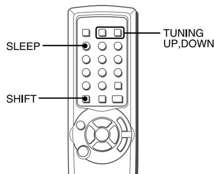
L'ampli-tuner peut être automatiquement mis hors tension à une heure précise.
