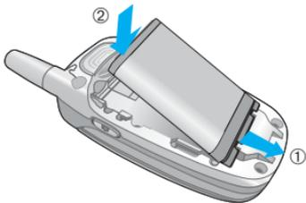
5. Appuyez sur la pile jusqu'à ce qu'elle soit bien en place (un clic sera audible). Vérifiez que la pile est correctement installée avant de mettre le téléphone en marche.
