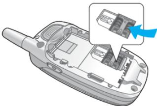
4. Placez la pile de manière à ce que les onglets d'extrémité soient alignés avec les fentes au bas du téléphone.
