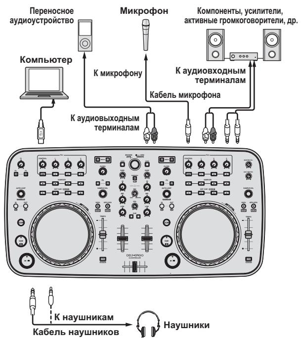
Питание на данный аппарат подается через питание шины USB. Аппарат можно использовать, просто подключив его к компьютеру через USB кабель.
