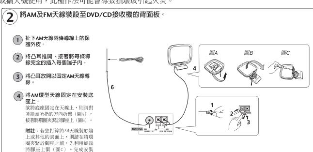
5 將AM天線置於平坦的表面上, 並對準收聽狀況最佳的方向 切勿讓天線觸及金屬物體,同時 應遠離電腦,電視機或其他電氣 設備的範圍擺設。
